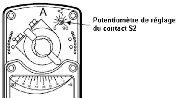
Figure 9 : Réglage du contact S2
