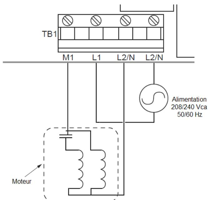
**Rappel :** la distance entre le variateur et les moteurs ne doit pas dépasser 15 mètres.
