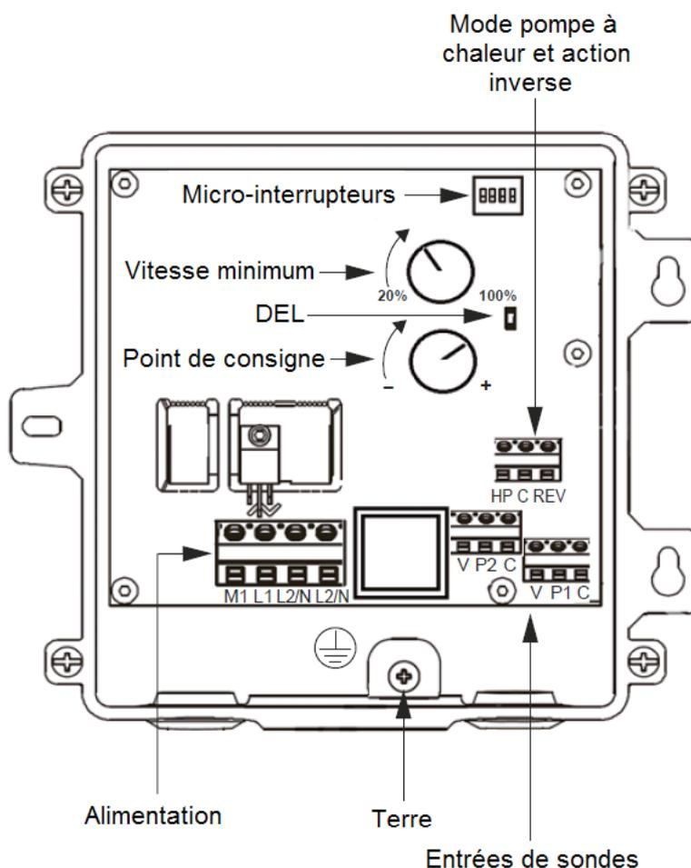
Les trois premiers micro-interrupteurs permettent de choisir la plage de fonctionnement et la bande proportionnelle parmi les quatre combinaisons pré-établies (voir ci-contre). Le quatrième micro-interrupteur définit le mode de fonctionnement en-dessous du point de consigne (ON = Vitesse minimum ; OFF = Arrêt complet).
