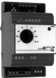
Ces modules de régulation de température peuvent être utilisés seuls pour des applications à 1 ou 2 étages ou comme thermostats maîtres pour les applications à plus de 2 étages. Dans ce cas ils doivent être connectés à des modules d'étages additionnels, le raccordement se faisant très
