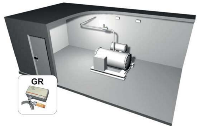
Figure 3 : Disposition des détecteurs de tuyauterie
