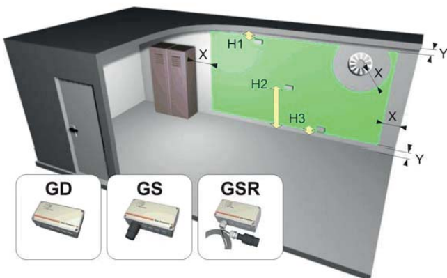
Figure 2 : Disposition des détecteurs d'ambiance
