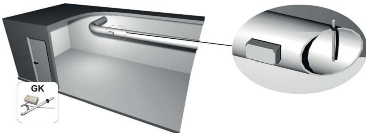
Figure 4 : Disposition des détecteurs de gaine
