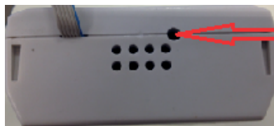
Logement du potentiomètre d'étalonnage
